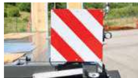
Panneaux de signalisation env. 423 x 423mm extensibles de \pm 400 mm avec 1 feu de position LED.
