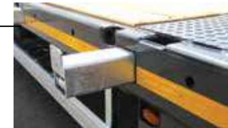
Elargisseurs galvanisés, extensibles d'env. 230mm par côté.
