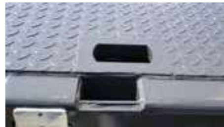
Pochettes conteneurs intégrées dans le plateau, pour des conteneurs 1 x 20".
