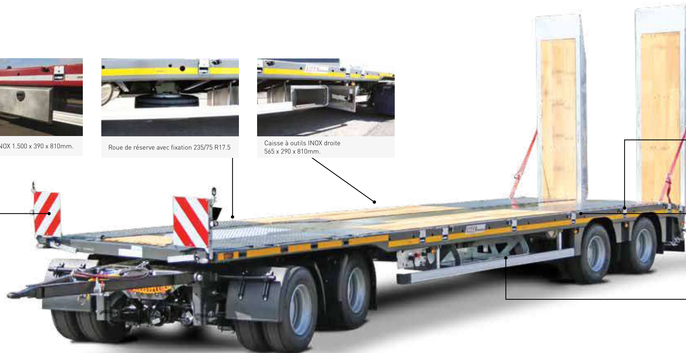
Panneaux de signalisation env. 423 x 423mm extensibles de \pm 400 mm avec 1 feu de position LED.
