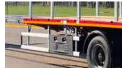
Une caisse à outils HDPE 1200x500x480 en dessous du plateau de chargement dans le sens de marche à gauche.
