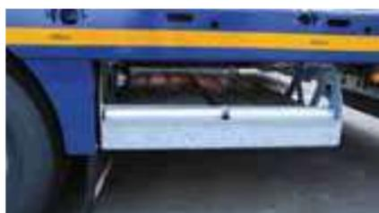
Support pour rampes en alu, installé transversalement derrière le bogie d'essieux.
