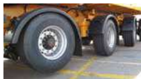
Premier essieu relevable (dépendamment de la charge) avec coussins d'air pour lever l'essieu.
