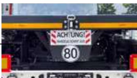
Une attache remorque boulonné à l'arrière de la semi-remorque.
