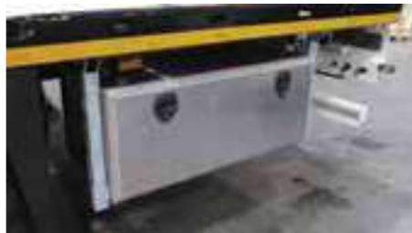
Une caisse à outils INOX 1.200 x 460 x 550 en dessous du plateau de chargement.
