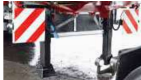
Panneaux de signalisation env. 423 x 423mm extensibles de ± 400mm avec 1 feu de position LED.
